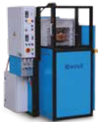
オイル槽付熱処理炉
