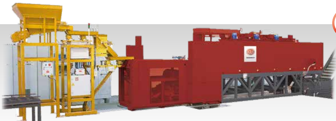
Four continu SOLO Swiss 302 avec trempe en ligne
