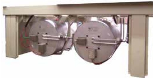
2 integrierte NH 3 Ammoniakspaltgas-Erzeuger
