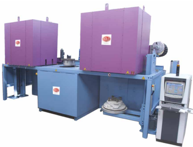
Völlig ausgerüsteter zusätzlicher Abschreckofen
